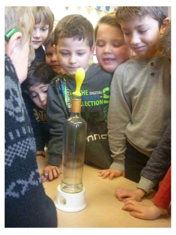
Tatsächlich, der Luftballon wird aufgeblasen. Das Teelicht erwärmt die Luft in der Flasche und die warme Luft steigt nach oben.
